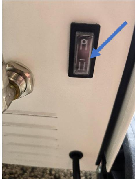
Laisser couler l'eau quelques secondes pour purger le réseau. Mettre l'interrupteur sur 0 puis visser la dernière buse
