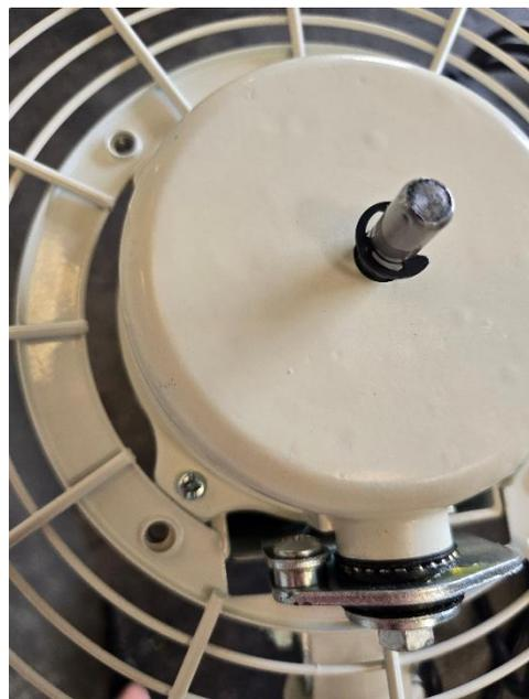
Replacer les 4 vis du moteur et bien serrer
