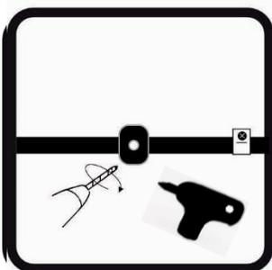
Percer le tube à travers le porte buse (A) à l'aide de la clé poinçon (G) ou d'un forêt de  $\varnothing 2$  à 3mm
